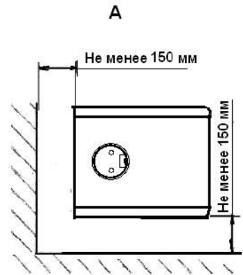
Схема установки котлов
